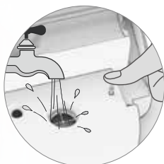
Нажмите кнопку блокировки и прочистите воздушный канал.
