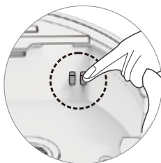
Металлические контакты на основном корпусе.
