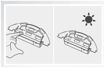
**Техническое обслуживание:** просушите бак для воды вручную, оставьте его сохнуть на воздухе.
