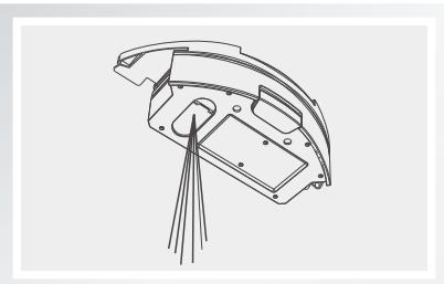
**Снимите:** после влажной уборки снимите ткань для влажной уборки и элементы, вылейте оставшуюся воду из бака для воды.
