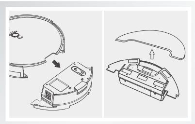
**Снимите:** после влажной уборки пожалуйста снимите элементы бака для воды и ткань для влажной уборки.
