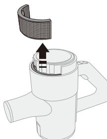
Снимите фильтр высокой очистки.
