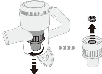
Поверните по часовой стрелке, чтобы снять фильтрующий элемент и снять фильтрующую сетку.
