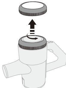
Поверните против часовой стрелки и снимите верхнюю крышку.
