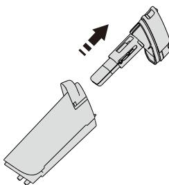
Вытащите крышку бака для грязной воды.
