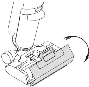
Нажмите на кнопку разблокировки передней крышки и снимите крышку.
