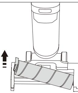
Поднимите держатель валика, чтобы вытащить валик.
