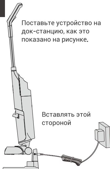
Теперь световой индикатор на корпусе загорится оранжевым, устройство войдёт в режим зарядки. Горячий зелёный индикатор указывает на то, что зарядка завершена (через 5 минут устройство перейдёт в спящий режим).
