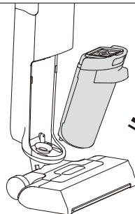
Нажмите на кнопку разблокировки бака для воды и вытащите бак.
