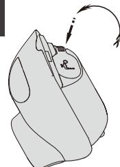
Чтобы закрыть мягкую резиновую крышку, поверните её против часовой стрелки и опустите.
