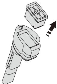
Вытащите держатель с губчатым фильтром из крышки бака для грязной воды.
